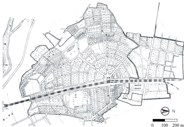
图4 1923年东京多摩川台的住宅区平面规划图:私铁+同心圆住宅区模式 资料来源:作者根据参考文献[27]绘制
